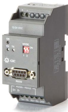
El convertidor de RS232 a RS485/RS422 permite la interface de cualquier dispositivo que utilice un enlace serial RS232 con un enlace RS485/RS422. La especificación RS485 permite conectar en red hasta 32 estaciones en las mismas líneas, con velocidades de hasta 10Mbps a distancias de 4,000 pies (1200 metros). Los enlaces RS485/RS422 son mas empleados en control de procesos industriales donde la confiabilidad es importante.
